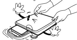
Batterien immer aus der Waage nehmen, wenn diese längere Zeit nicht benutzt wird. Beschädigungen durch ein etwaiges Auslaufen können so verhindert werden.
