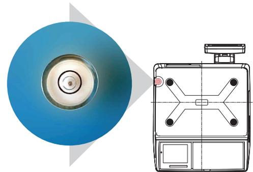
Korrigieren Sie den Stand der Waage mittels der justierbaren Schraubfüße unterhalb der Waage solange, bis die Wasserblase zentriert ausgerichtet ist und die Waage nicht mehr wackeln kann.
